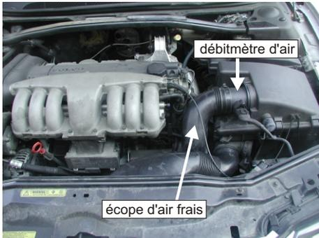
Désaccoupler le débitmètre d'air ainsi que l'écope d'air de la boîte à air.
