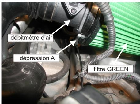
Emboîter le filtre GREEN sur le débitmètre d'air.
