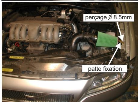
Positionner la patte de fixation sur l'aile avant gauche puis effectuer un perçage de 08.5mm.
