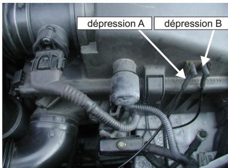
Débrancher le tuyau de dépression A de la boîte à air.
