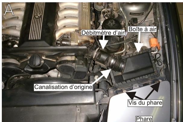
Déposer et supprimer les boîtes à air complètes, pour cela il est nécessaire de déposer les phares.(schéma A et C)
